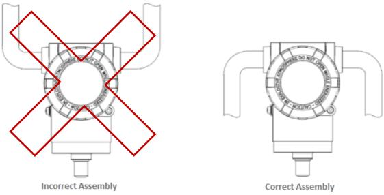
Figure 2.10 - Conduit installation.
